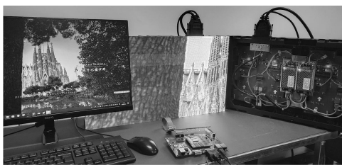
图 10 LED 显示平台(软件、控制系统、显示屏)
